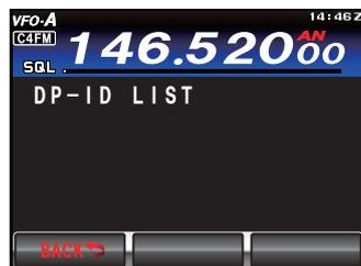
3. Pendant que la liste DP-ID est affichée, une émission en mode C4FM numérique provenant de l'autre émetteur-récepteur enregistre le DP-ID. Lorsqu'un signal est reçu d'une autre station, l'indicatif et l'identifiant de la radio s'affichent sur l'écran LCD.
