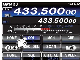
3. Appuyez sur le bouton **UP** ou **DWN** du microphone pendant une seconde, ou appuyez sur le bouton **F(M-LIST)** suivi de **[SCAN]** pour commencer à balayer dans la direction spécifiée.
