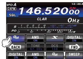
Un maximum de 24 stations utilisant la fonction GM dans la portée de communication s'afficheront sur l'écran TFT.
