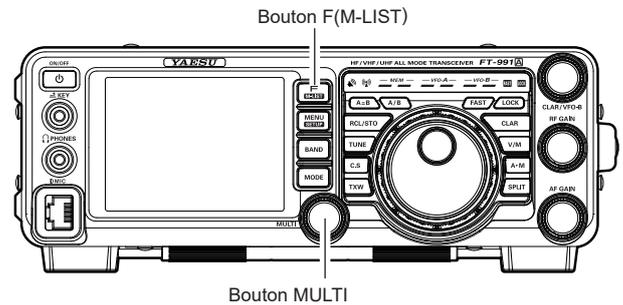
3. Appuyez sur le bouton **UP** ou **DWN** du microphone pendant une seconde, ou appuyez sur le bouton **F(M-LIST)** suivi de **[SCAN]** pour démarrer le balayage dans la direction spécifiée sur la fréquence VFO.
