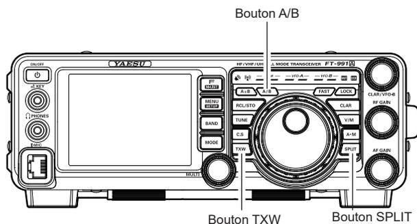
Pendant le trafic en Split, le registre VFO-A sera utilisé pour la réception tandis que le registre VFO-B sera utilisé pour l'émission. En appuyant à nouveau sur le bouton **SPLIT**, le fonctionnement en Split sera annulé.
