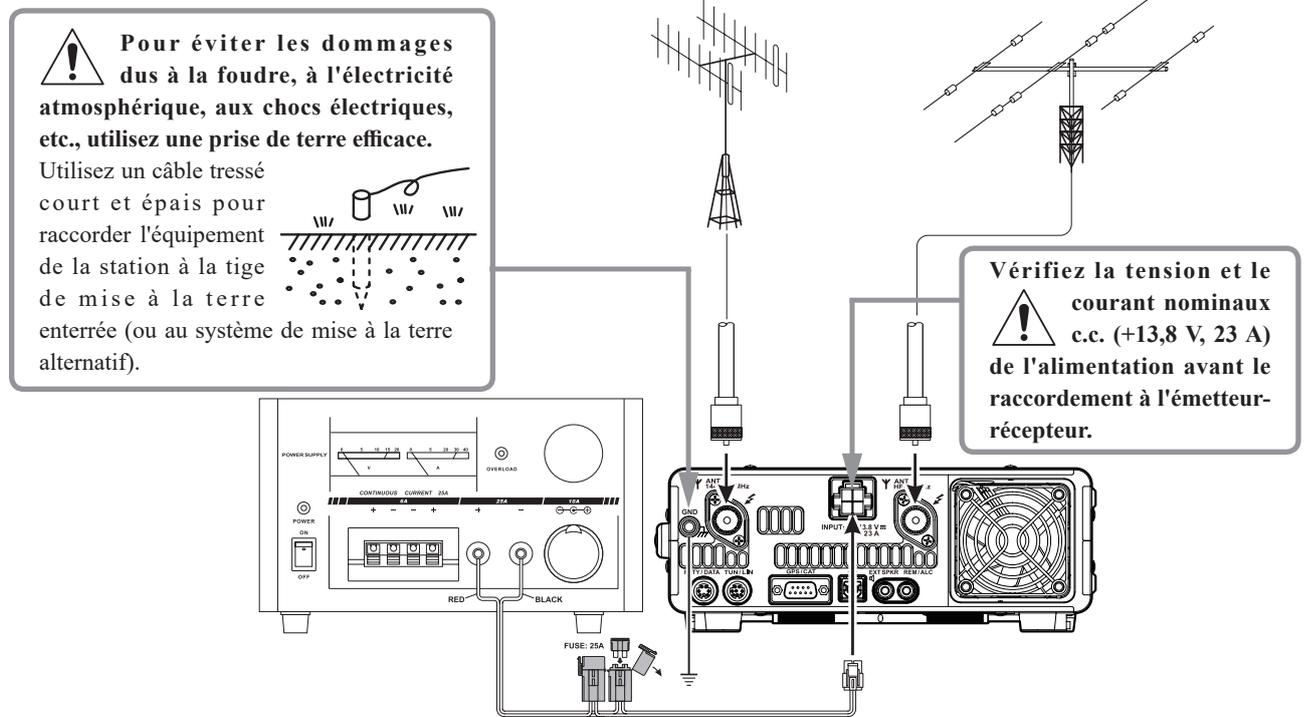
Il est recommandé d'utiliser l'alimentation c.a. **FP-1030A** (marché américain seulement). D'autres modèles d'alimentation peuvent être utilisés avec le **FT-991A**, cependant les recommandations de tension d'entrée 13,8V c.c., de courant de 23 ampères et de polarité du câble c.c. décrites ci-dessus doivent être strictement respectées.
