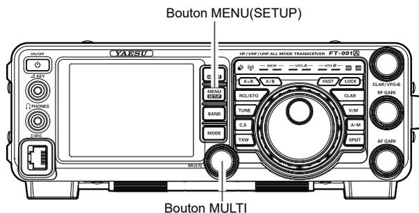
4. Lorsque le réglage ou la configuration est terminé, touchez [**ENTER**] sur l'écran LCD pour enregistrer le nouveau paramètre, puis appuyez sur le bouton **MENU(SETUP)** ou touchez [**BACK**] sur l'écran LCD pour revenir au fonctionnement normal.
