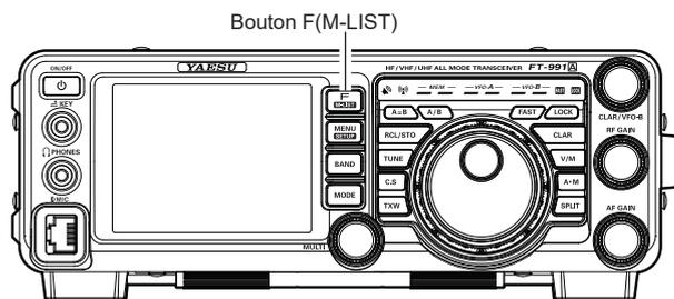
2. Si nécessaire, le niveau du suppresseur de bruit peut être ajusté avec l'entrée de menu "025 NB LEVEL" jusqu'à ce que le bruit perturbant soit réduit ou éliminé correctement. Voir l'encadré ci-dessous pour plus de précisions.
