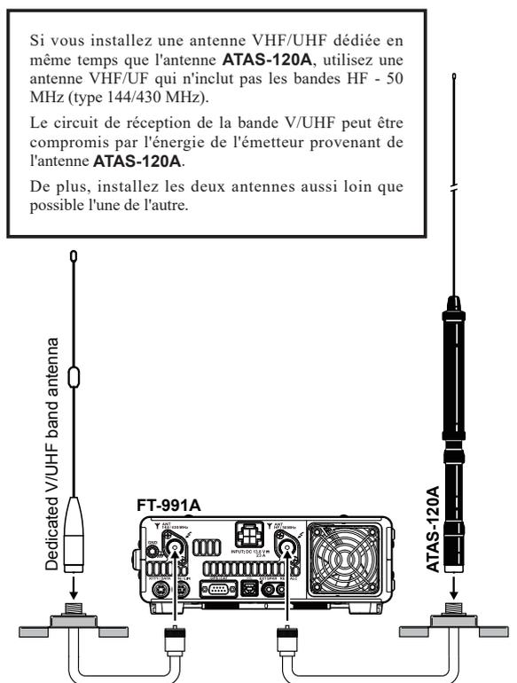
Si vous utilisez un duplexeur d'antenne, la borne ANT de l'antenne **ATAS-120A** et la borne ANT HF/50 MHz du **FT-991A** doivent être branchées en série et isolées de la terre pour fournir la tension de commande pour l'antenne **ATAS-120A**.
