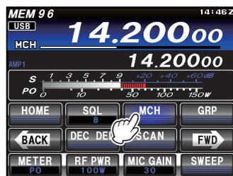
3. Les canaux de mémoire (de "5-01" à "5-10") sont préprogrammés en usine avec les fréquences autorisées dans la bande de 5 MHz, et le mode USB ou CW est automatiquement sélectionné sur ces canaux.
