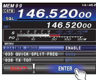
5. Appuyez sur le bouton **MENU(SETUP)** ou sur **[BACK]** sur l'écran LCD pour revenir au fonctionnement normal. Le fonctionnement sera ainsi limité aux six groupes Mémoire.
