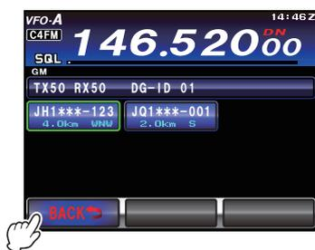
Les autres stations doivent aussi activer la fonction GM. Il est possible de déterminer l'indicatif, la distance et la direction d'un maximum de 24 stations opérant avec la fonction GM active, configurées avec le même identifiant DG-ID et se trouvant à portée de communication. Tournez le bouton MULTI pour sélectionner les autres stations.
