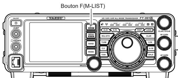
Pour désactiver le filtre NOTCH numérique, il suffit de répéter la procédure ci-dessus, en touchant **[DNF]** sur l'écran LCD pour choisir "OFF". L'icône "DNF" s'éteindra pour confirmer que le filtre NOTCH numérique est pas actif.
