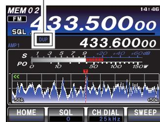
6. Appuyez sur le bouton **A►M**. Vérifiez que le canal de mémoire où est enregistrée la fréquence de réception est sélectionné.
