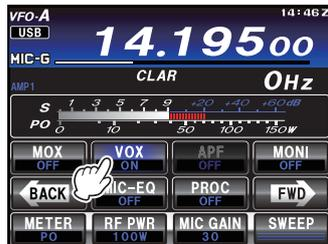
2. Sans appuyer sur l'interrupteur **PTT**, parlez dans le micro avec un niveau de voix normal. Lorsque vous commencez à parler, l'émetteur doit être activé automatiquement. Une fois que vous avez fini de parler, l'émetteur-récepteur doit revenir au mode de réception (après un bref délai).
