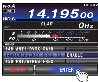
5. Appuyez sur le bouton **MENU(SETUP)** ou sur [**BACK**] sur l'écran LCD pour revenir au fonctionnement normal. Les communications d'urgence sur cette fréquence ponctuelle sont maintenant possibles.
