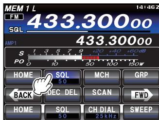
6. Tournez légèrement le bouton d'accord principal (pour activer le réglage de la mémoire). L'accord et le balayage sont à présent limités à la plage comprise dans les limites P-1L/P-1U, jusqu'à ce que vous appuyiez à nouveau sur le bouton **V/M** pour revenir au canal de mémoire ou au fonctionnement VFO.
