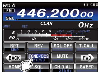
3. Touchez plusieurs fois **[TONE/DCS]** sur l'écran LCD pour sélectionner le mode CTCSS désiré. Si le répéteur nécessite une tonalité de codage à liaison montante, sélectionnez "ENC". Pour l'opération de codage/décodage à liaison montante et descendante, choisissez "CTCSS". Les choix disponibles sont:
