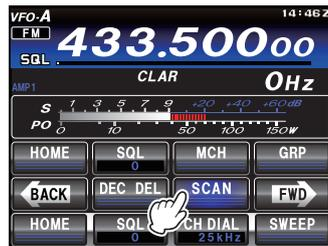
4. Si le balayage s'arrête sur un signal entrant, le point décimal entre les chiffres "MHz" et "kHz" de la fréquence affichée clignote.
