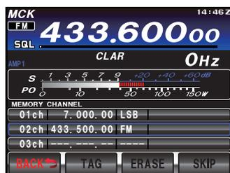
7. Pour enregistrer la fréquence d'émission, appuyez sur le bouton **PTT** du microphone et maintenez-le enfoncé tout en appuyant sur le bouton **A►M**. Un double bip confirme que le bouton **A►M** a été maintenu enfoncé suffisamment longtemps et que les données sont enregistrées. Une fois l'écriture en mémoire terminée, la fréquence de réception s'affiche sur l'écran.
